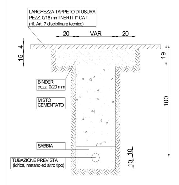
si prescrive l'impiego, a rinforzo della pavimentazione stradale in conglomerato bituminoso, di una griglia in poliestere, con maglia quadrata (lato di 40x40 mm), saldamente accoppiata ad un tessuto ultraleggero microfonato in polipropilene, il tutto impregnato da strato bituminoso; la griglia dovrà essere posizionata nello spessore del "binder"
