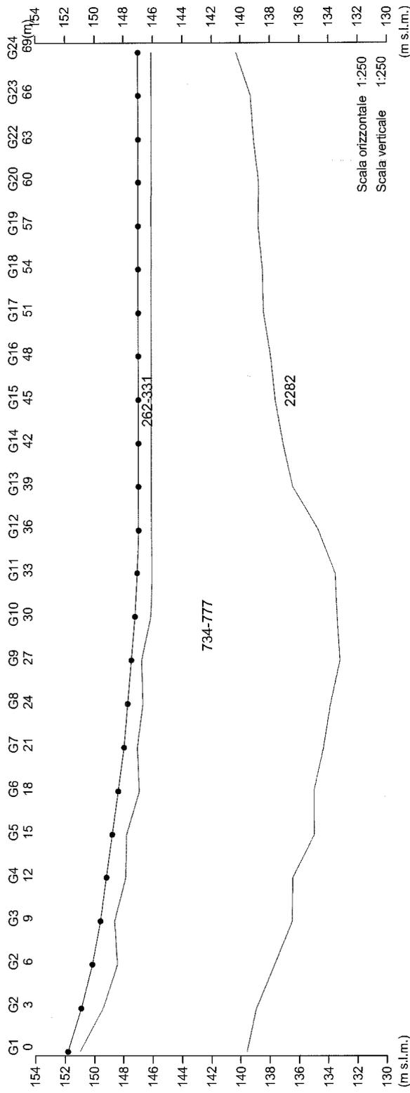
**Profilo di sismica a Rifrazione Ps2**
