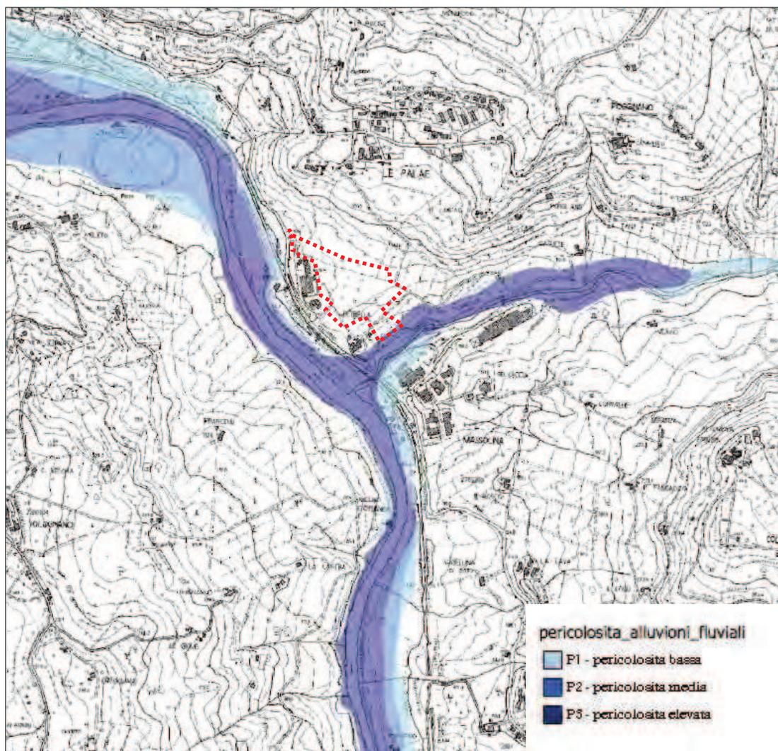
FIG.6 – CARTA DELLA PERICOLOSITA' IDRAULICA (ESTRATTO DAL PIANO DI GESTIONE RISCHIO ALLUVIONI DEL FIUME ARNO)
